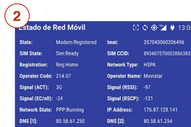
El sistema muestra una pantalla con todos los dato útiles para verificar el estado de las comunicaciones del equipo.
